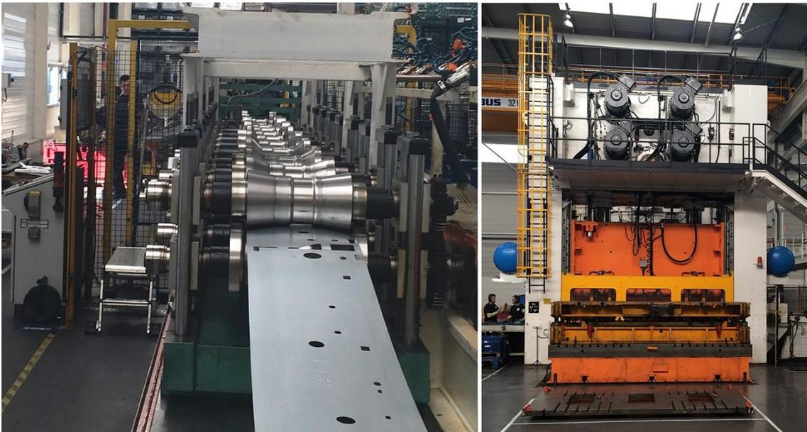
Figura 1. Perfiladora y prensa de SNOP ESTAMPACIÓN S.A.
